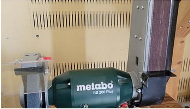
Metabo 604220000 Kombi-Bandschleifmaschine 600W Band-Breite 50mm Band-Länge 1020mm
