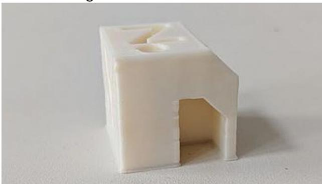
Testwürfel gedruckt mit dem Anet A8
