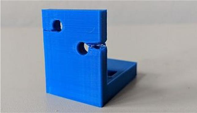
Messwürfel mit dem Ender-2 ohne Bauteilkühlung gedruckt
