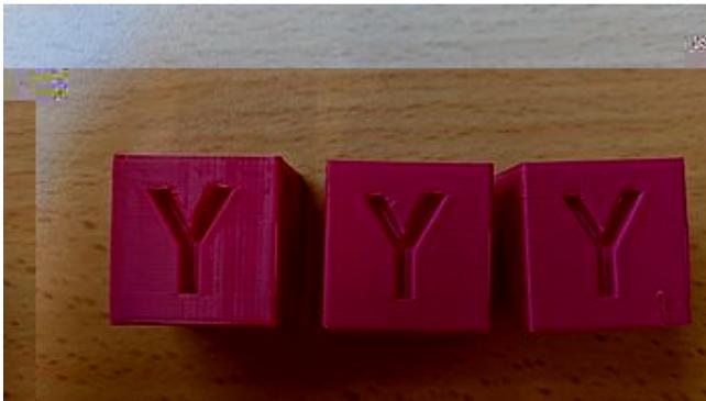
XYZ-Cube zum Überprüfen der Druckparameter
